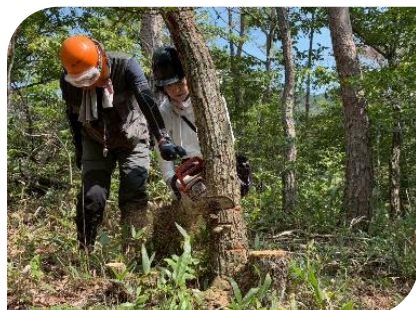
チェーンソーでの伐倒作業。指導員の指導による受け口作り。
