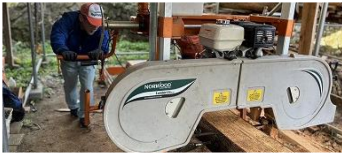
簡易製材機にてスギの丸太を製材中。
