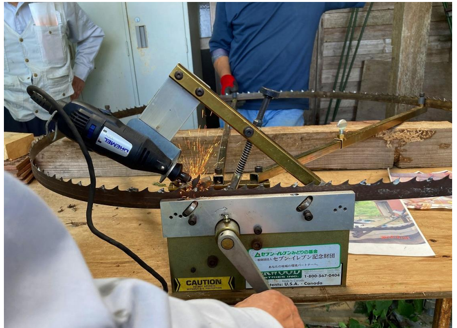
～後進へ技術の継承を:電動目立て機で目立て中～ 簡易製材機講習会 part2 P3にて報告
