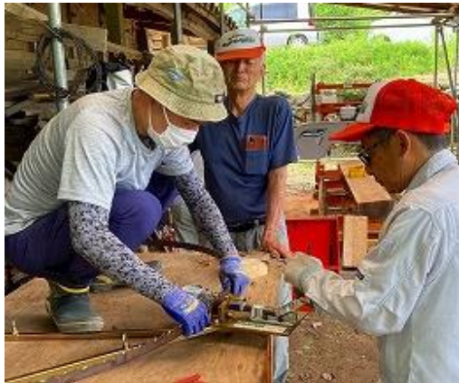
製材機ブレード(刃)のアサリを作る
