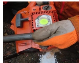
チェーンソーに取り付けた水準器。水平を確保する(左)。ポインターと曲尺で伐倒方向を確認(右)
