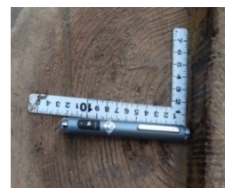
チェーンソーに取り付けた水準器。水平を確保する(左)。ポインターと曲尺で伐倒方向を確認(右)
