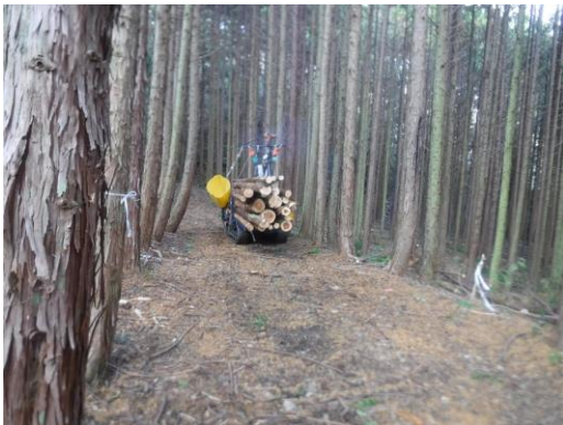
林内運搬車を使用して土場まで運搬
