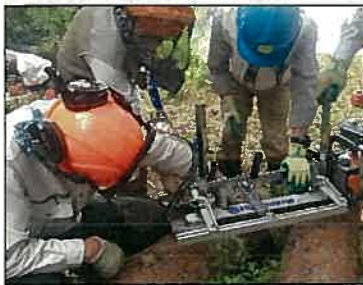
知恵を出し合い簡易製材機を使用
